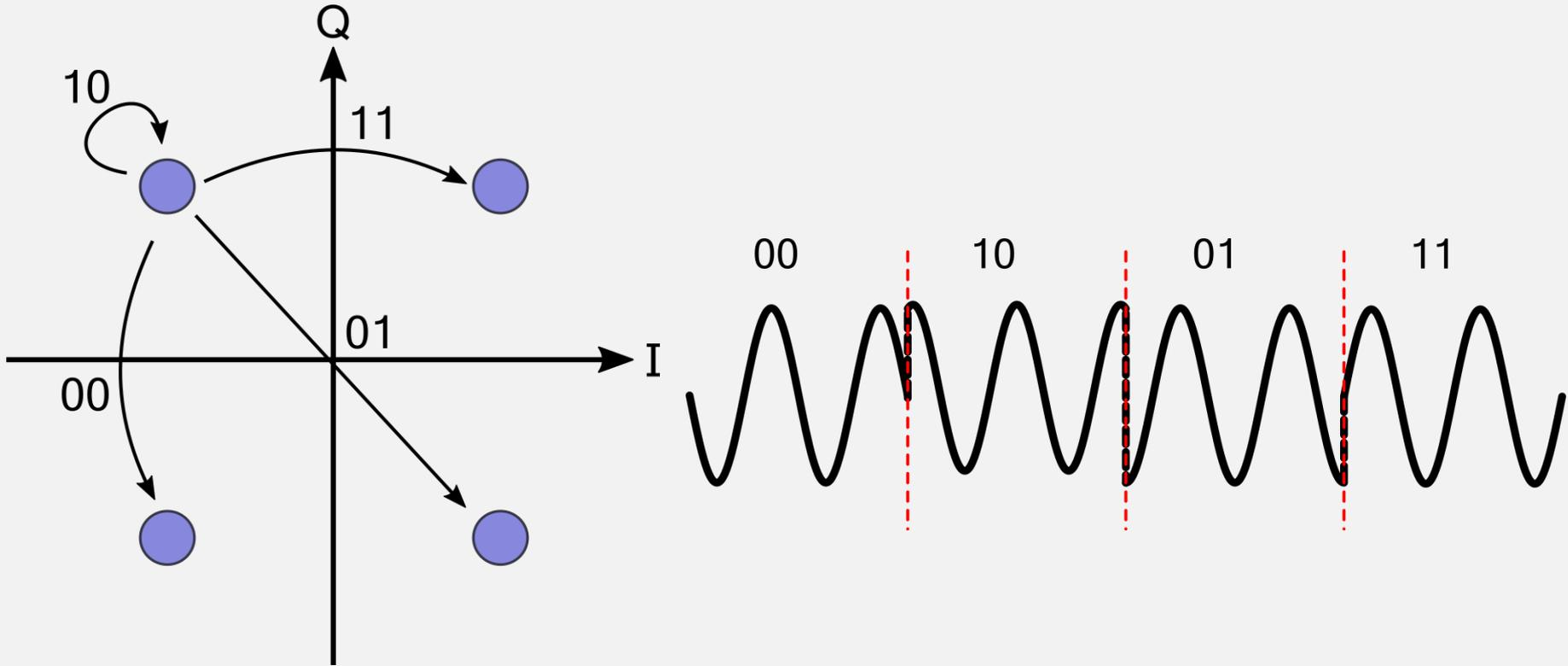
DQPSK modulation alleviates RX phase synchronization requirements
